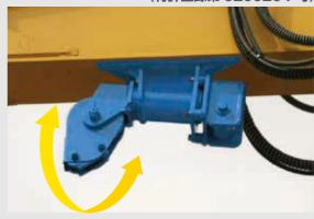
自在に回転する滑車により、集材時の乱巻きを防止します。
